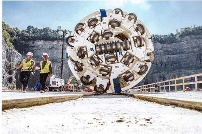
Robbins tarafından imal edilen 3,8 m çapındaki köstebek, 8,0 km uzunluğundaki Bellwood Tüneli'ni, granit kayaç içerisinde kazıyor ve yer yer tünele su girişleriyle karşılaşıyor
